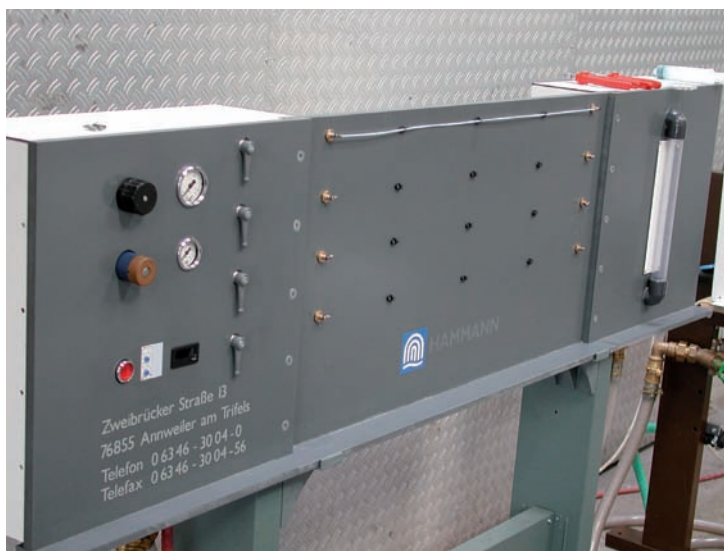
Abbildung 2: Teststand zur Reinigung von Endoskopschläuchen mittels Complex-Verfahren.
