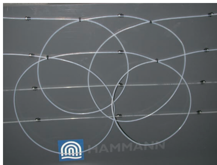
Abbildung 3: Teststand mit Endoskopschläuchen vor der Reinigung mittels Complex-Verfahren.
